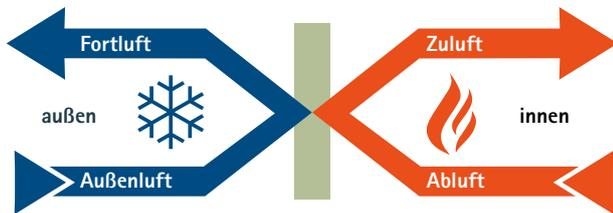
Abb. 8: Wärmetauscher
