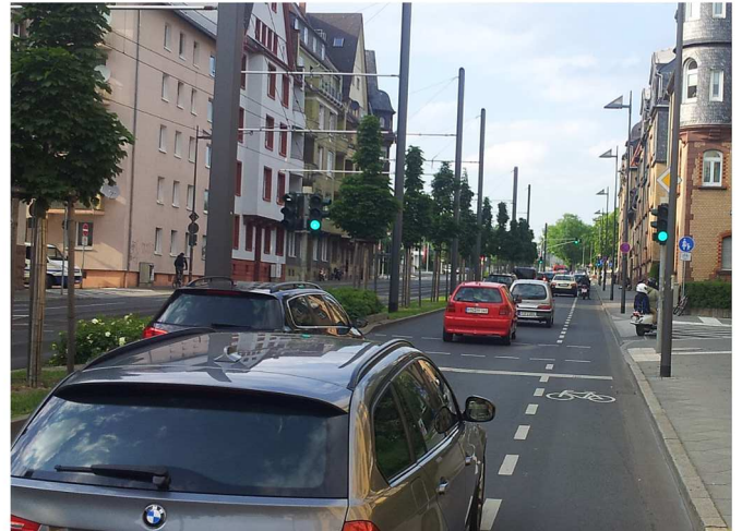
Abbildung: Schutzstreifen in Kombination mit überbreitem Fahrstreifen in Frankfurt am Main
