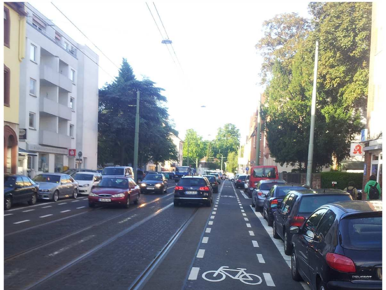
Abbildung: Schutzstreifen in Frankfurt am Main
