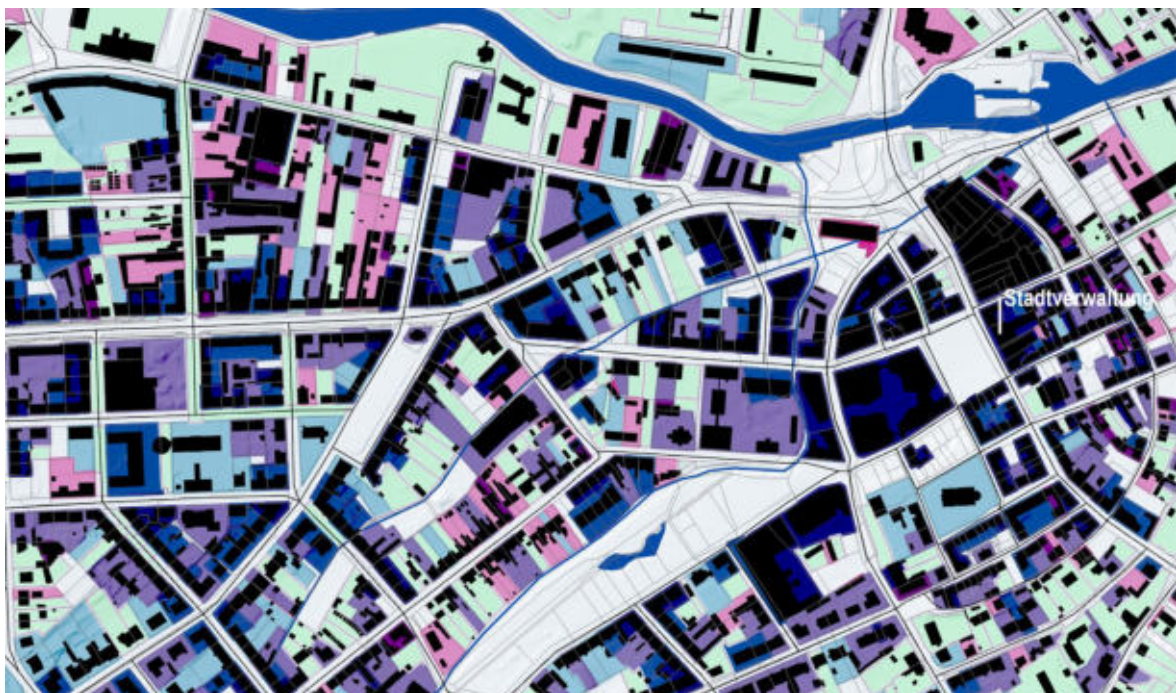
Abbildung 50 Detailausschnitt Themenkarte „Grundflächenzahl (GRZ) und Geschossflächenzahl (GFZ)“ (A3-Übersichtskarte zum gesamten Untersuchungsraum siehe Kapitel 9.3).
