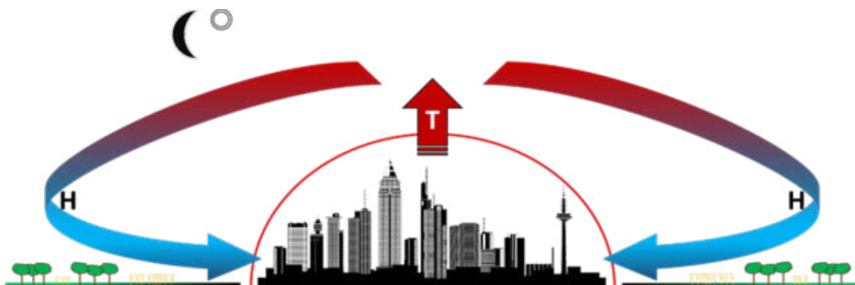
Abbildung 7 Schematische Darstellung eines Flurwindsystems am Beispiel des Stadt-Umland-Windsystems. Die wärmere "Stadtluft" steigt wegen ihrer geringeren Dichte auf, während die kühlere "Landluft" absinkt. Durch diesen Luftdruckgegensatz entsteht ein Wind vom Land in der Stadt.
