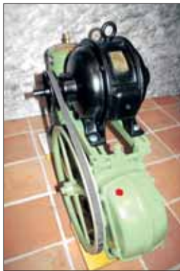
Elektrische Kolbenpumpe ca. 1930, von der Fa. Holtzmann, Angermünde. Für den Auftritt extra frisch gestrichen.
