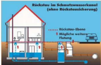
Da die angeschlossenen Grundstücksentwässerungen mit dem System zusammenhängen, steigt auch in Hausanschlüssen, Kontrollschächten und Grundleitungen das Abwasser, bis es die Höhe der Rückstauwetter erreicht hat. Damit werden tiefer liegende Kellerräume bis zur Höhe der Rückstauwetter durch Abwasser aus dem öffentlichen Netz (und natürlich durch eigenes Abwasser, das nicht mehr abfließen kann) geflutet.
