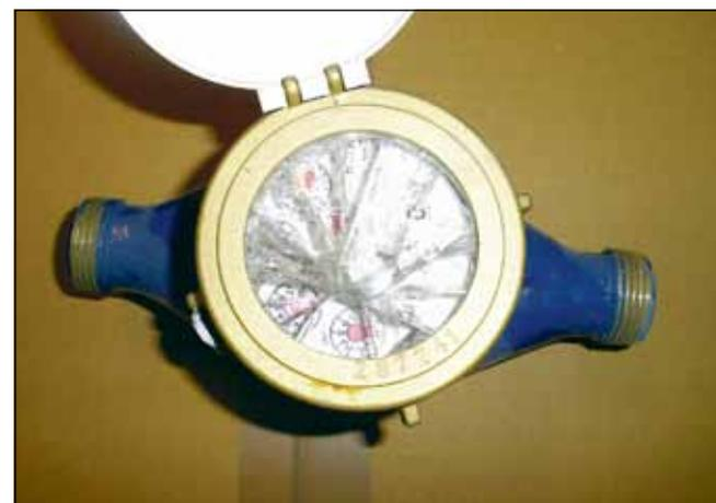
**Ausgebauter Wasserzähler, vom Frost zerstört**
