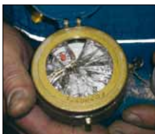
Ausgewechselter, vom Frost zerstörter Wasserzähler
