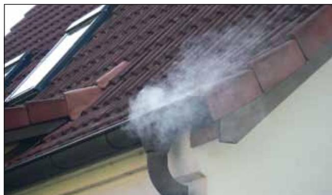
Mit dieser Methode hat der ZWA in der Vergangenheit immer wieder Falschanschlüsse, z. B. an die Schmutzwasserentsorgung angeschlossene Dach- und Hofentwässerungen aufgedeckt.
