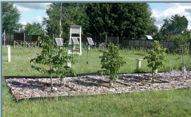
links: Die Lysimeteranlage auf der Versuchsstation „Drachenkopf“ mit den in den Boden eingelassenen Lysimetergefäßen mit jungen Bäumen bepflanzt (Vordergrund) sowie Niederschlagssammlern und Wetterstation (Hintergrund) | rechts: Prinzipskizze eines Lysimeters
