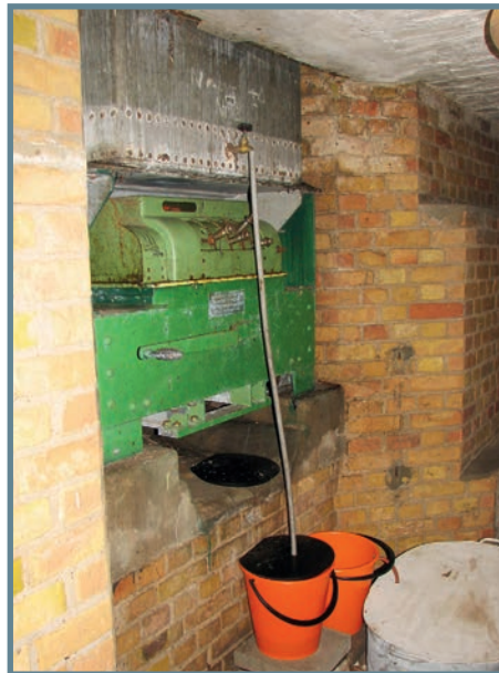
Messung der Sickerung am Lysimeterboden und Waage aus dem Jahr 1929
