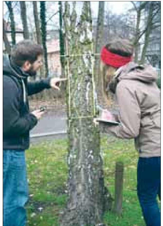
Kartierung mit Aufnahmegitter nach VDI
