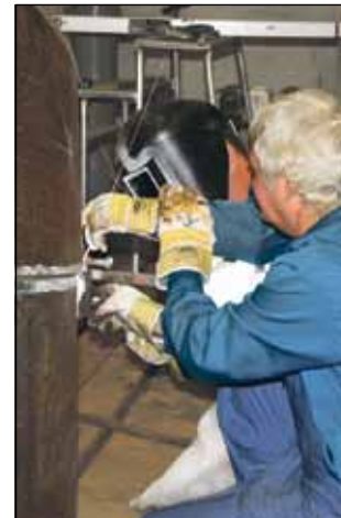
Schweißerarbeiten an einem Spezialrohr in der Finow Rohrsysteme GmbH.
