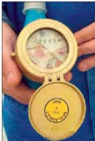
Ausgewechselter, vom Frost zerstörter Wasserzähler
