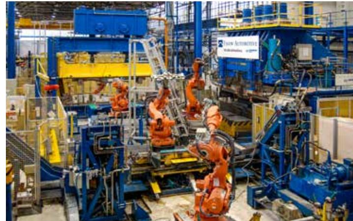
Abb. 15: Roboterlinie mit 130.000 kN Hydroforming-Pressen zur Fertigung von Längsträgern für Land Rover, Finow Automotive-Archiv, Eberswalde-Finow
