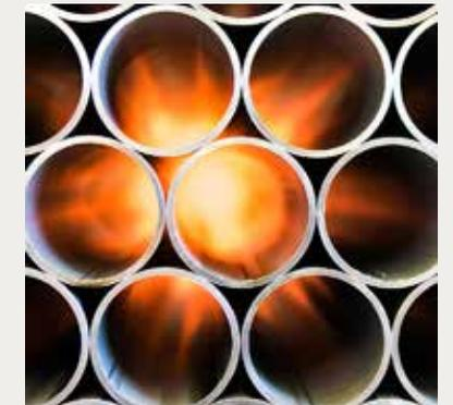
Abb. 2: Vormaterial für Pkw-Rahmenelemente: 6 Meter lange und gebündelte Stahlrohre
