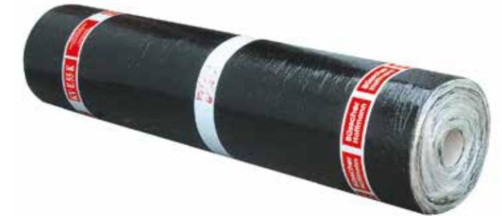
Abb. 18: Elastomerbitumenbahn „Baruplan“ mit Kunststoffvlies-Einlage von Büsscher & Hoffmann, Kältebiegsamkeit -20°C, Wärme- standfestigkeit +100°C, B&H-Archiv, Enns
