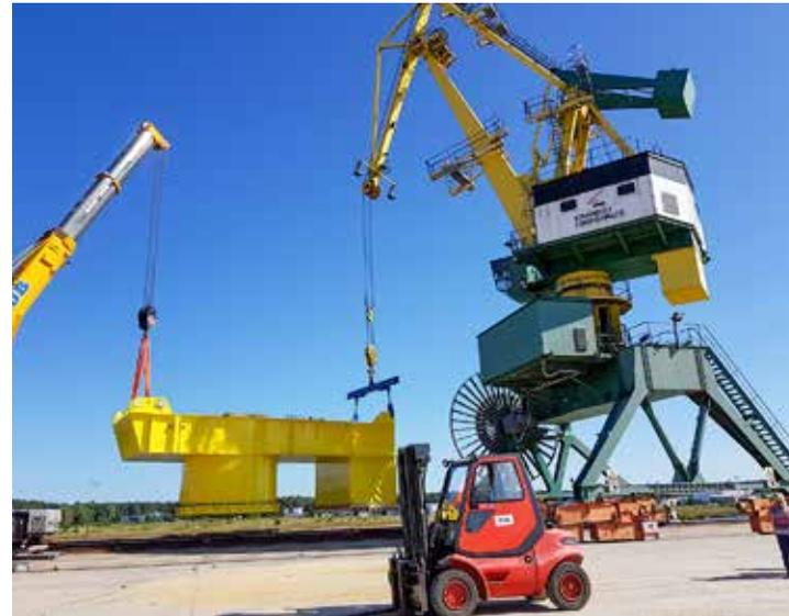
Abb. 3: Doppellenker-Hafenkran „Tukan 3000“ bei der Verladung der Maschinenhausplattform für den 125 Meter hohen MV Werft Montagekran in Wismar, Ardelt-Archiv, Eberswalde
