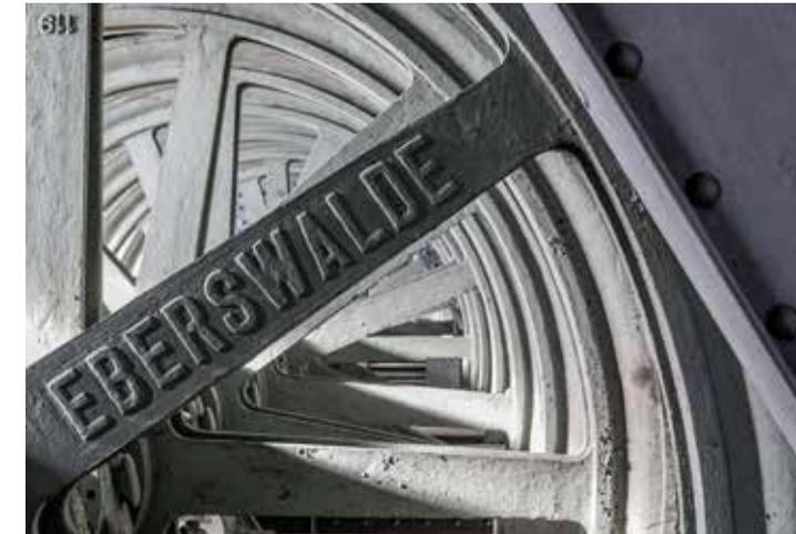
Abb. 9: Original Seilrollen der Ardelt-Werke Eberswalde aus dem Jahr 1934 im Schiffshebewerk Niederfinow
