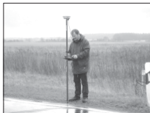
GPS Vermessung einer Leitung
